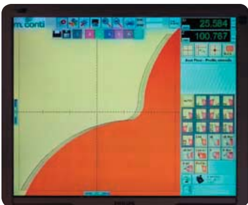
Comparazione di più taglienti sagomati. Comparaison de plusieurs profils d'outils Comparing multiple shaped cutters.
