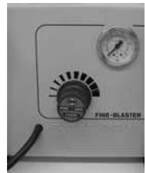
Manuelle Strahldruckeinstellung Manual blasting pressure adjustment Ajustage manuel de la pression de sablage
